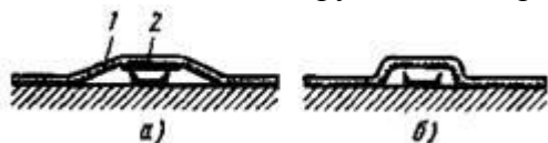
Рис. 1.1. Выполнение обхода препятствий проводом (жгутом проводов):
